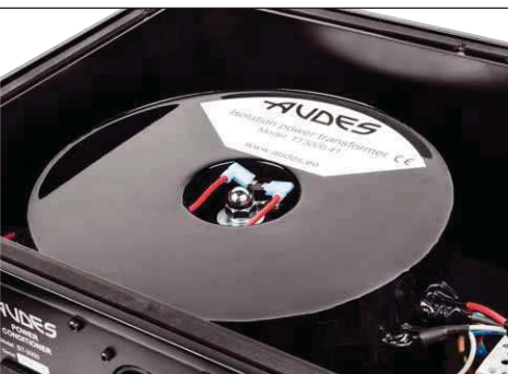
Der 3kVA-Ringkerntrafo ist ein Kaliber, das man nicht alle Tage zu sehen bekommt
